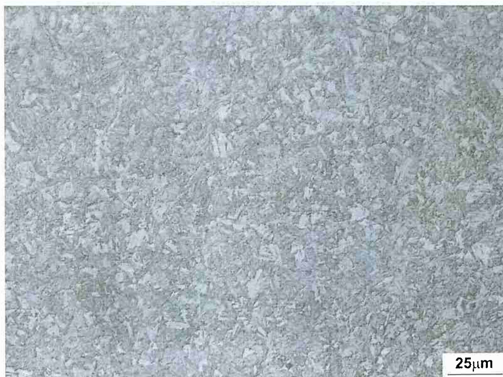
Figura 27 - Micrografia da região C2 da amostra I. Aumento 500x
